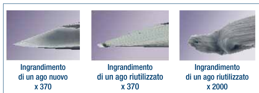
Figura 3. Le fotografie mostrano i diversi danni a un ago quando viene riutilizzato (da Lok e Strauss, 1998, mod.) 13 .
